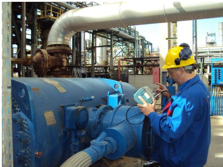
***Manutenzione predittiva prove non distruttive su macchine elettriche ed impianti industriali sotto tensione***
