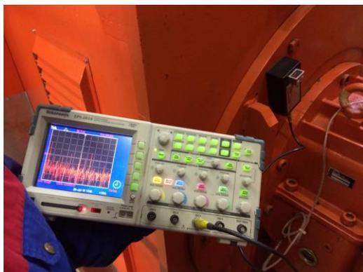
L'analisi spettrale della vibrazione mediante FFT (Fast Fourier Transform) rende unica la nostra diagnostica per rilevare e **localizzare** le anomalie vibrazionali (e.g. parti rotte all'interno della macchina in esame, ventola sganciata, cinghia allentata) e dei guasti incipienti nei cuscinetti, negli avvolgimenti dello statore, nel rotore e nell'accoppiamento con la macchina utilizzatrice.
