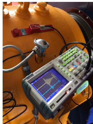
Tutte le misure DIACS delle scariche in una macchina elettrica vengono eseguite in conformità allo Standard IEEE 1434-2.000.
